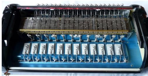
**Main droite** : entre 46 et 72 boutons suivant sa destination (professionnel ou élève). D'innombrables ressorts maintiennent l'ensemble sous tension et donnent la douceur et le nerveux désiré au clavier.
